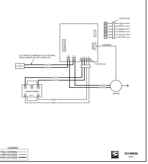
Figure 16. MB7EM (208/240V) Wiring Diagram
