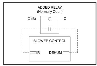
Figure 19. DHUM to Relay Wiring Configuration
