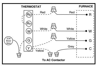
Figure 25. Thermostat Wiring
