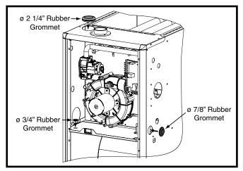
Figure 28. Rubber Grommets
