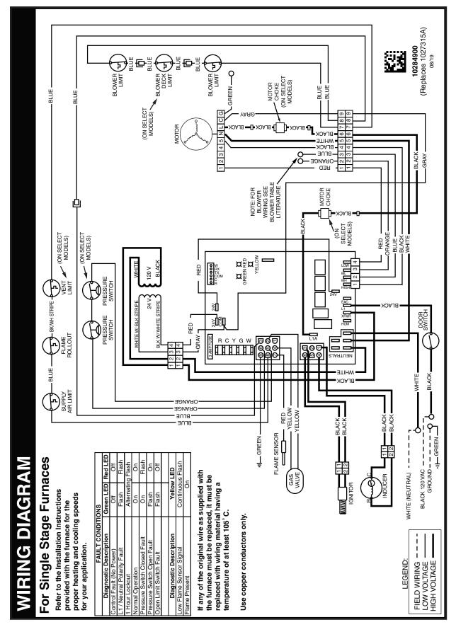
Figure 31. Nordyne/UTEC Wiring Diagram
