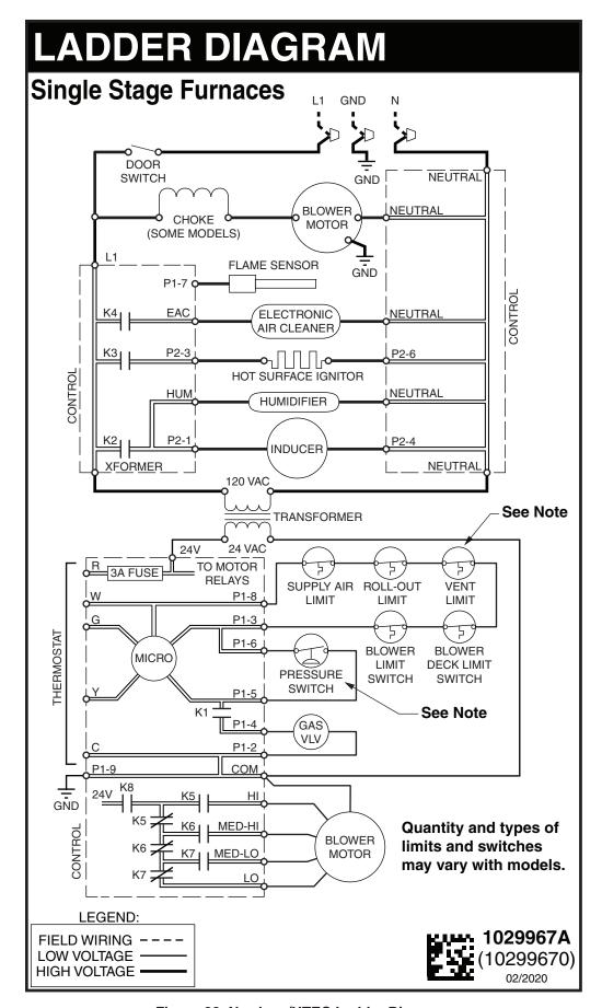
Figure 23. Nordyne/UTEC Ladder Diagram
