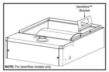
Figure 33. VentilAire<sup>™</sup> Bracket
