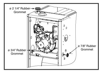
Figure 28. Rubber Grommets
