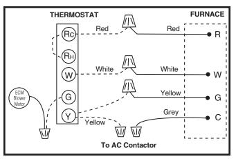
Figure 25. Thermostat Wiring
