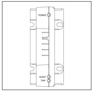
Figure 2. Comfort Alert<sup>™</sup> Diagnostics Module
