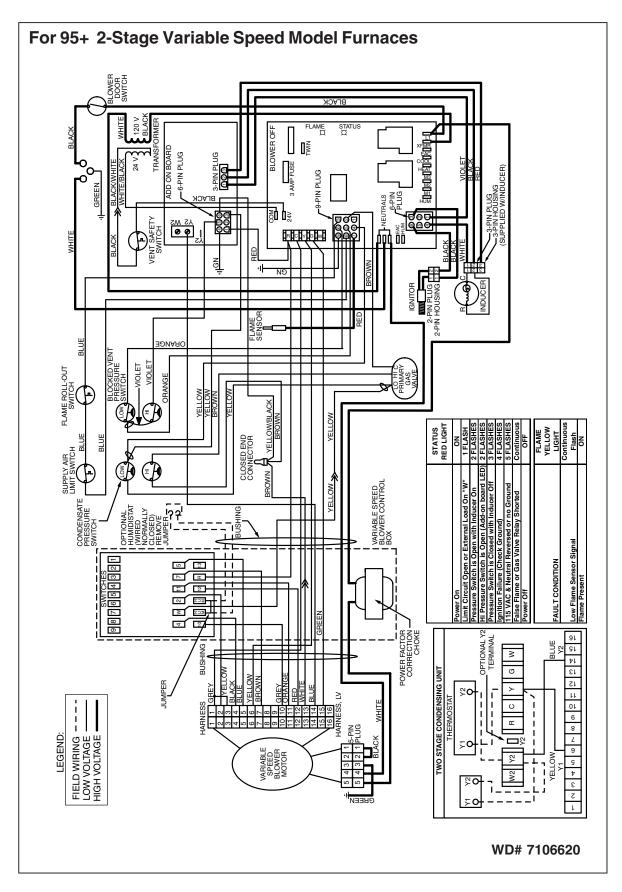
Figure 29. Wiring Diagram
