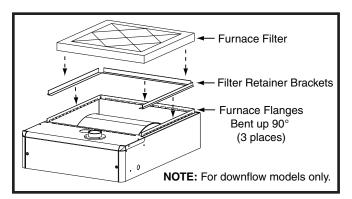
Figure 30. Filter Retainer Brackets
