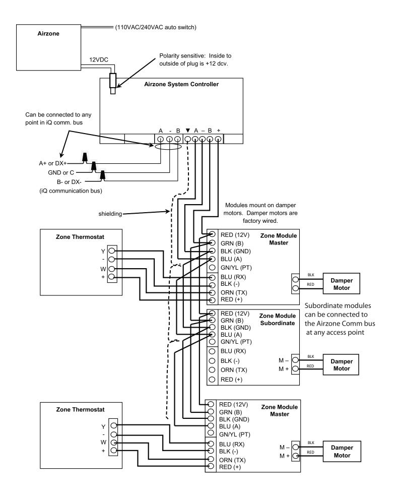
Figure 28. iQ Zone Control Wiring
