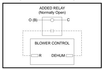
Figure 19. DHUM Wiring Configuration
