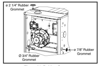
Figure 21. Rubber Grommets
