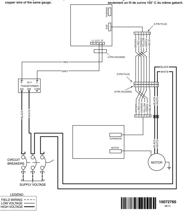
Figure 16. MB7EM (460 V) Wiring Diagram
