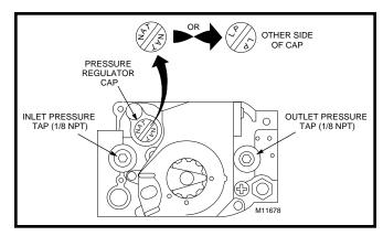
Figure 28. Honeywell Gas Valve
